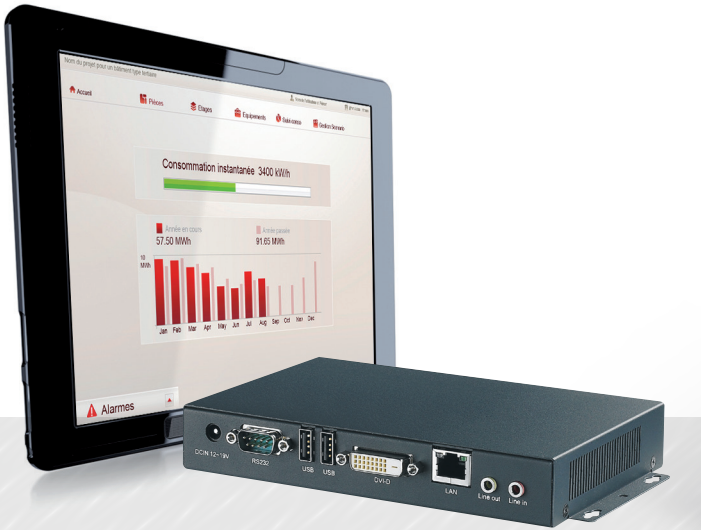
32 ÖLÇÜM NOKTASININ TABLET BİLGİSAYAR VE WEBSERVER ÜZERİNDEN GÖRÜNTÜLENMESİ
