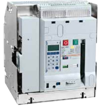
DMX 3 4K, 2500A, 65kA çekmeceli tip şalter. Üzerine ref. 0 288 02 elektronik koruma ünitesi monte edilmiş
