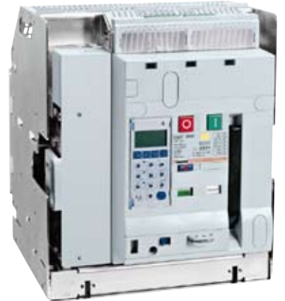
DMX 3 4P, 2500A, 65kA çekmeceli tip şalter. Üzerine ref. 288 02 elektronik koruma ünitesi monte edilmiş
